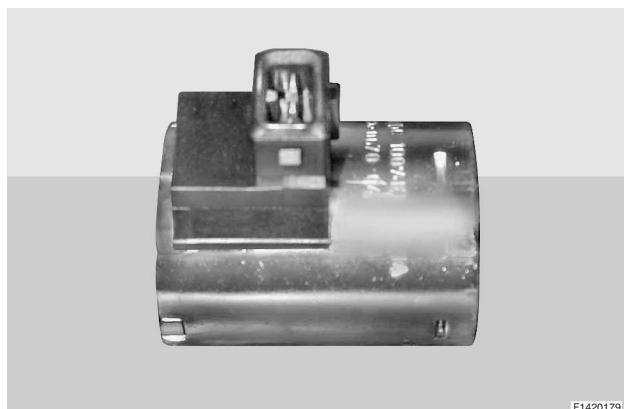
Per convertire la elettrovalvola da 12V a 24V sostituire solo il solenoide con il ricambio a cod. 3312 199 062.
